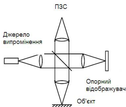
Рис. 1. Оптична схема інтерференційного мікроскопа Лінніка
