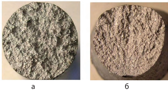
Рис. 1 Изломы литых образцов сплава МЛ5, х5: а – без Hf; б – 1,0 % Hf.
