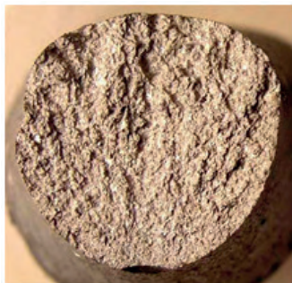
Рис. 1 Макрофрактограммы излома образца из сплава МЛ5 легированного 0,1 % Zr, x5
