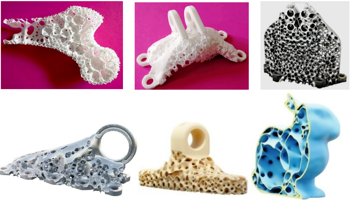
Рис. 2. Приклади друківаних полімерних і металевих виробів типу корала чи кістки, кронштейнів та декоративної фігурки (з сайту https://spherene.ch )
