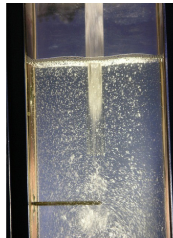
Рис. 1. Розвиток кільцевих вихорів при газоімпульсному обробленні розплаву камфена
